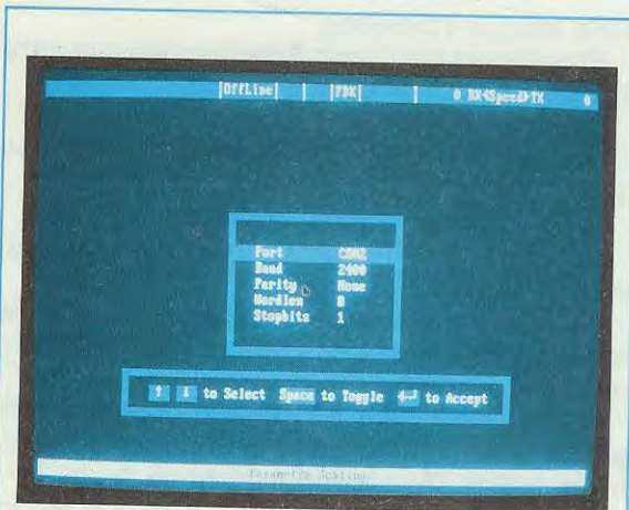
Fig.4 La prima operazione da compiere è quella di configurare la porta seriale premendo i tasti ALT P e la barra spaziatrice.
