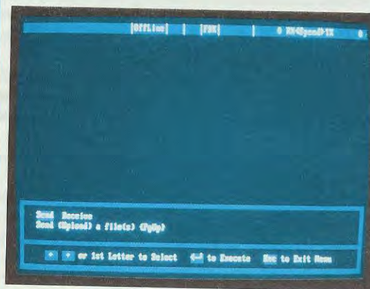
Fig.8 Premendo dal menu principale la lettera F, apparirà questa finestra dove potrete ricevere o trasmettere dei files.
