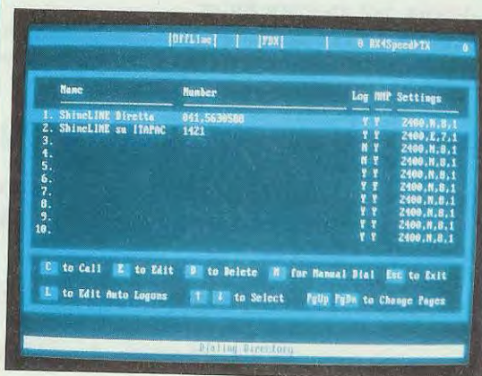
Fig.6 Nella pagina della rubrica telefonica dovete inserire i numeri telefonici delle banche dati ed il settaggio N Y 2400,N,8,Y,1.
